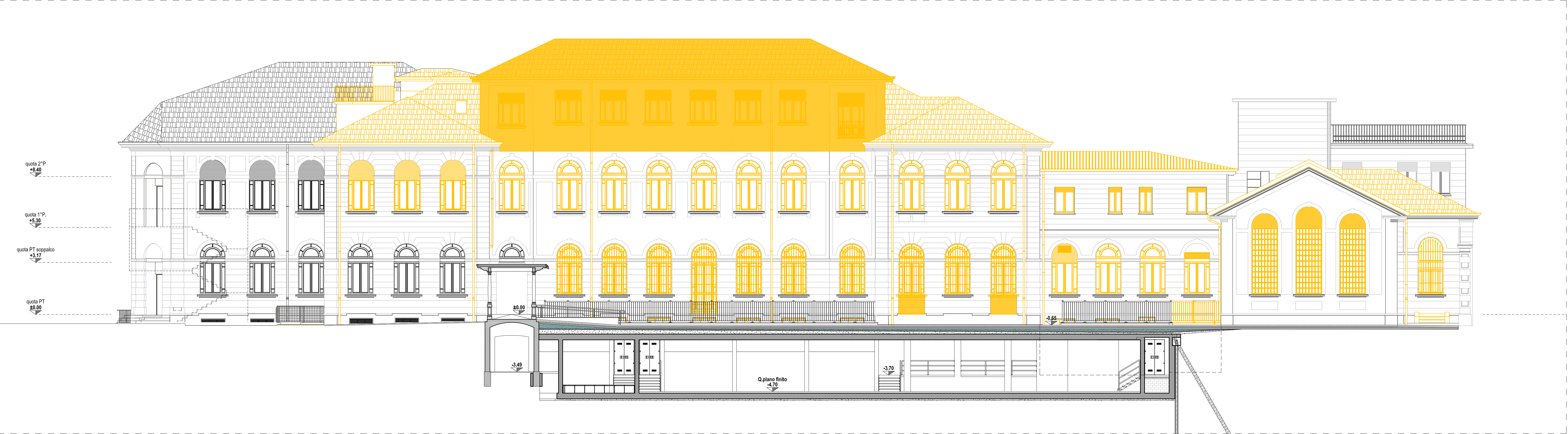
DEMOLIZIONI - PROSPETTO EST (scala 1:100)
