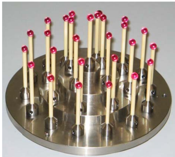
Figura 4 – Esempio di campione materiale per la valutazione del parametro E_{MPE} .
