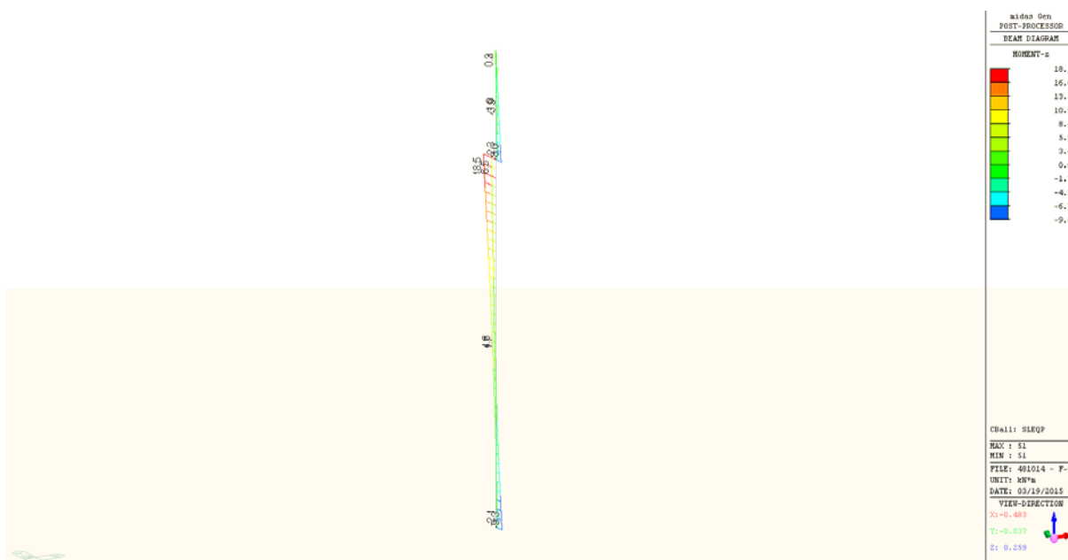
Figura 3.7 - Pilastro 1: involucro momenti Mz combinazioni SLE quasi permanente.
