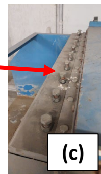
Figura 4.1: (a) tratto terminale del canale; (b) condizione al contorno di valle composta da lamelle verticali mobili per occludere progressivamente l'area di passaggio; (c) sistema di movimentazione delle lamelle.
