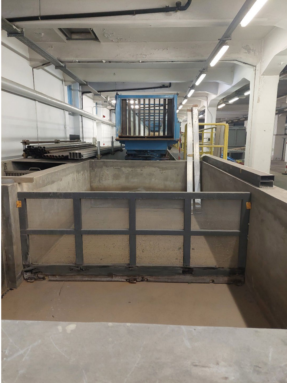
Figura 2.1: foto che mostra la fine del canale idraulico e la vasca sottostante di raccolta dell'acqua
