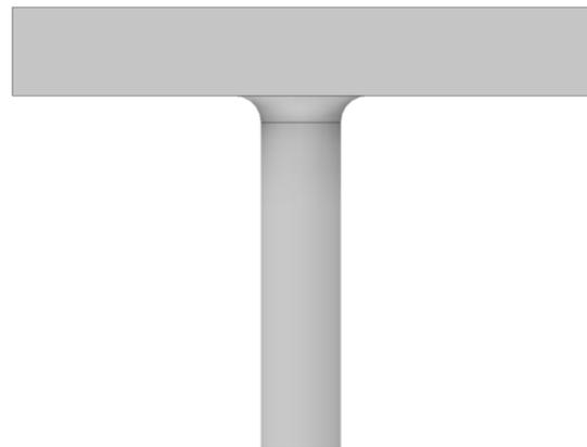
Esempio di base inferiore dove la parte cilindrica verrà utilizzata come interfaccia per le prove meccaniche, mentre la piastra superiore serve come collegamento con la parte inferiore del componente (si veda come esempio a sinistra)
