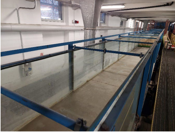
FIG. 1: Canale idraulico: vista interna
